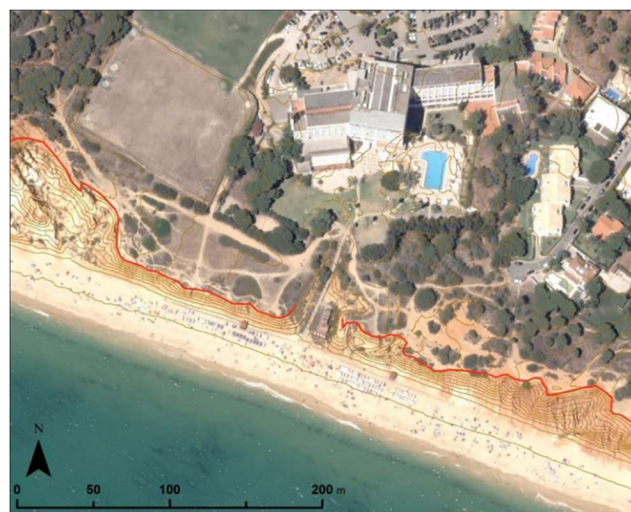
Figura 76 - Fotografia aérea de 2018 (Município) com curvas de nível com equidistância de 2 m criadas a partir do levantamento LIDAR de 2008 (DGT) e crista de arriba (a encarnado) desenhada com base na mesma topografia.
