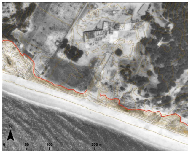
Figura 73 - Fotografia aérea de 1974 (D.G.S.U, Algarve Fieda 19, fotografia n.º 2189 fotografia 758, junho de 1974) com curvas de nível com equidistância de 2 m criadas a partir do levantamento LIDAR de 2008 (DGT) e crista de arriba (a encarnado) desenhada com base na mesma topografia. A interrupção na linha da crista da arriba corresponde à localização do atual acesso à praia.
