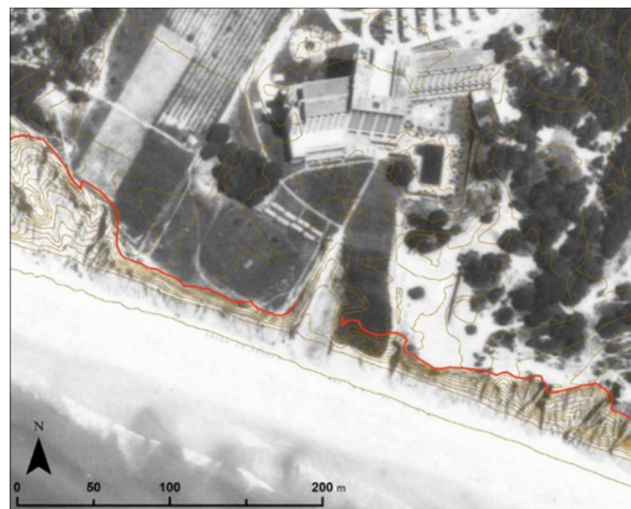
Figura 74 - Fotografia aérea de 1980 (FAP, fotografia 758, de 6 de maio de 1980) com curvas de nível com equidistância de 2 m criadas a partir do levantamento LIDAR de 2008 (DGT) e crista de arriba (a encarnado) desenhada com base na mesma topografia.
