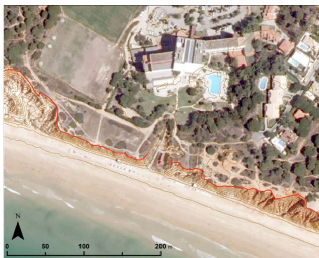
Figura 75 - Ortofoto de 2012 (DGT) com curvas de nível com equidistância de 2 m criadas a partir do levantamento LIDAR de 2008 (DGT) e crista de arriba (a encarnado) desenhada com base na mesma topografia.
