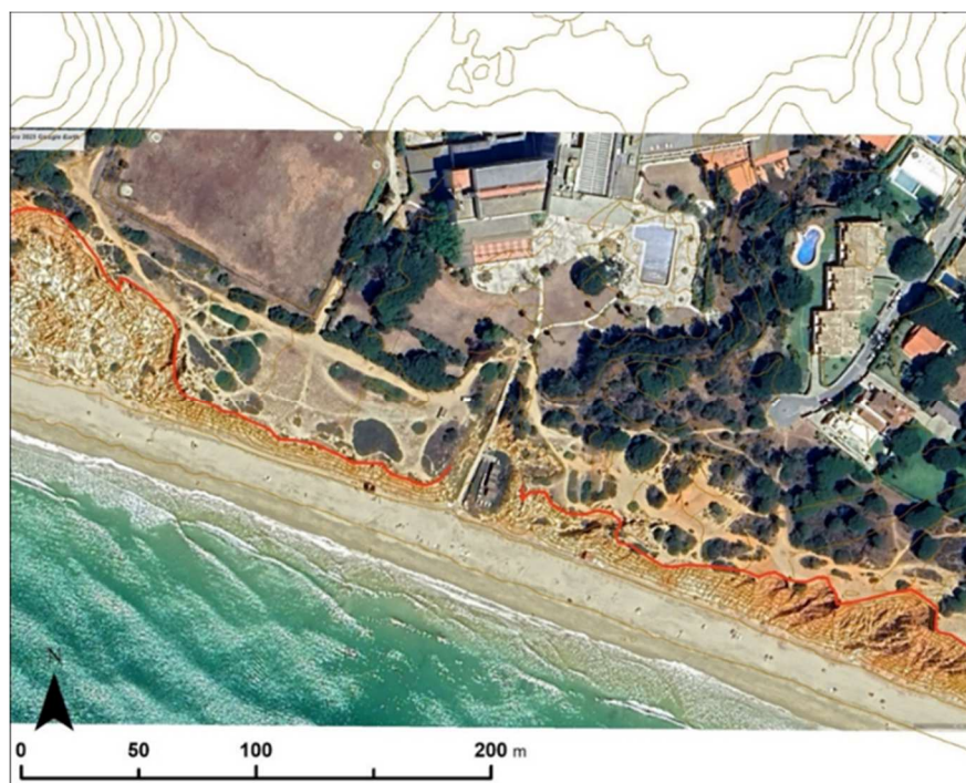
Figura 77 - Fotografia aérea de maio de 2023 (Google Earth Pro) com curvas de nível com equidistância de 2 m criadas a partir do levantamento LIDAR de 2008 (DGT) e crista de arriba (a encarnado) desenhada com base na mesma topografia.
